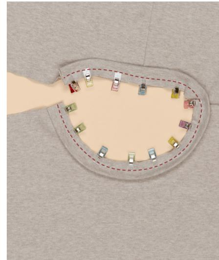
**4** Stecke das Halsbündchen rechts auf rechts in das Halsloch des T-Shirts. Du kannst dich hier an den Knipse orientieren, das Halsbündchen hat Knipse an der Vorderen Mitte, Schulternaht und Hinteren Mitte. Nimm hier lieber mehr Stecknadeln oder Klammern, um das Halsbündchen gut anzustecken. Leg die Schulternaht beim Annähen nach hinten und versäubere nach dem du die Naht geschlossen hast.
