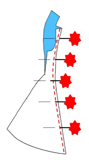
Die mittlere Naht an den Vorderteilen nähen
