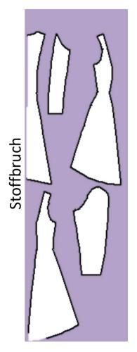
So wird das Futter aufgelegt, im Rücken brauchst Du hier keine Naht zu schneiden
