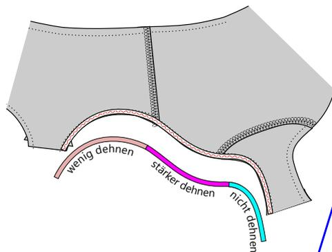
Gummiband mit Zickzackstich auf die Beinausschnittkanten nähen (auf die linke Stoffseite)
