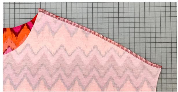
Nähe Vorderteil und Rückenteil an den Schultern rechts auf rechts aufeinander. Ich habe mit der Overlock genäht und den Differentialtransport genutzt, damit die Naht nicht ausgedehnt wird. Bügle die Nahtzugabe Richtung Rückenteil.
