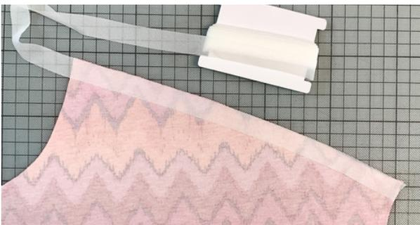
Damit sich die Schulternaht nicht ausdehnt, kannst du vor dem Nähen ein Nahtband aufbügeln. Dies empfiehlt sich vor allem, wenn du mit der Haushaltsnämaschine nährst.
